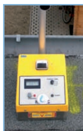
Neutronenprobe zur Beurteilung von Feuchteschäden (z. B. Dämmschichten)
